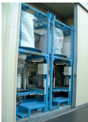
Vaciado y dosificación de Big Bag para productos higroscópicos
